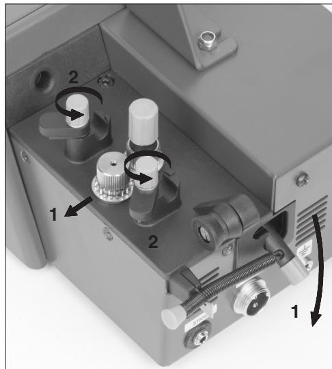
3. Bringen Sie die Führungsschlauch-Garnitur an der Steuereinheit an. Ziehen Sie die Befestigungsschrauben fest.
