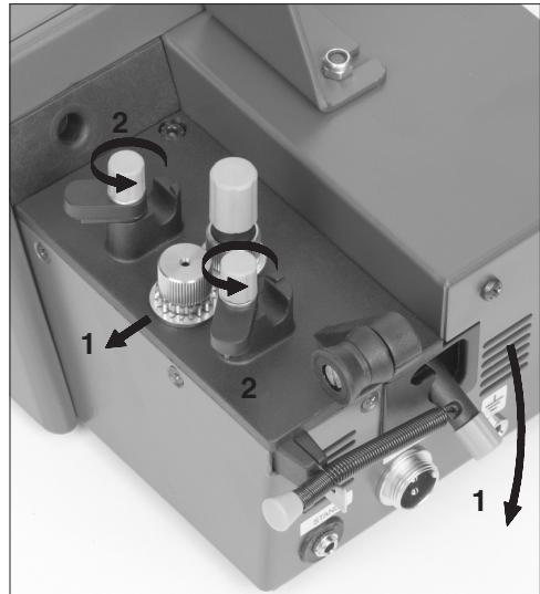
3. Coloque el juego de tubos y guías en la unidad de control. Apriete los tornillos de sujeción.
