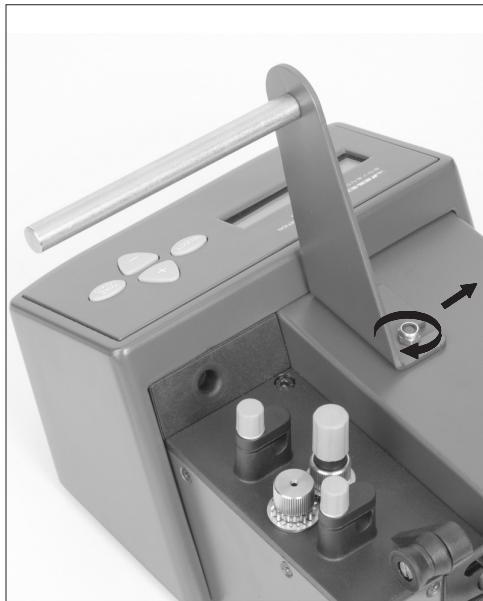
Setzen Sie die Drahtspelmuffen und die Spule ein (Höchstgewicht 1 kg). Ziehen Sie die 2 Schrauben fest.
